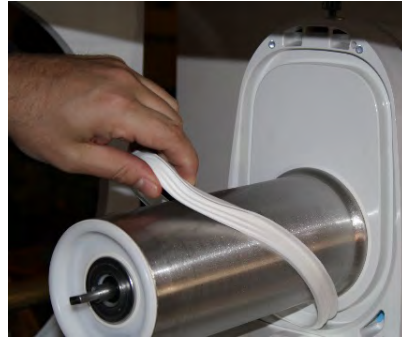
11. Poista tiiviste ja puhdista se. Remove the bowl gasket and clean it.
