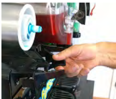
10. Irroita suojalevy ja pese se. Remove the cover plate and wash it.
