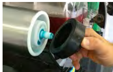
9. Vedä magneetilla kiinnitetty nappiosa pois (voi olla tiukka) ja puhdista se. Pull the knob out and clean it.
