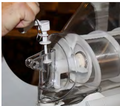
13. Irrota annostelukahva vetämällä ylöspäin. On tiukka. Pull the handle out towards the top. It is hard to pull.
