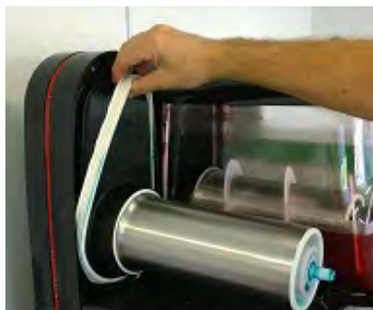
11. Irroita säiliön tiiviste vetämällä pois ja pese se huolellisesti. Remove the bowl gadget by pulling out and wash it carefully.
