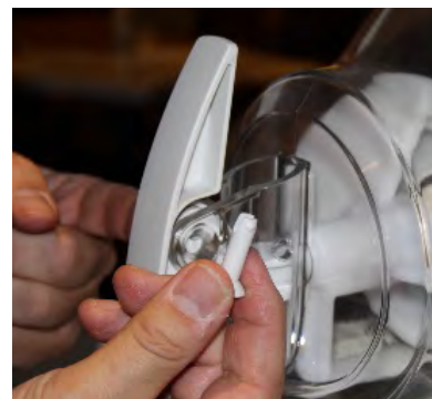
12. Irroita säiliön annostelukahvasta nappi vetämällä ja sormella työntämällä. (Slush kahva on musta / tässä kahva valkoinen) Remove the handle pin pulling and pushing it with your finger. Here the handle's colour is white – in the real world Slush's handle colour is black.
