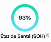
Capacité utile restante / Capacité utile neuve (2)
