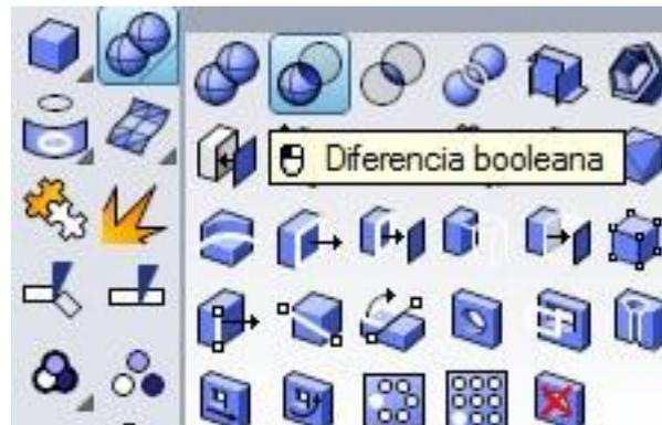
Para activar esta opción, ir al ícono de los volúmenes interseccionados y clicar en **Diferencia booleana**. Escoger el volumen principal y presionar **Enter**. Luego el volumen por restar y presionar **Enter**. De esta manera el volumen quedará como se presenta en la imagen adjunta:
